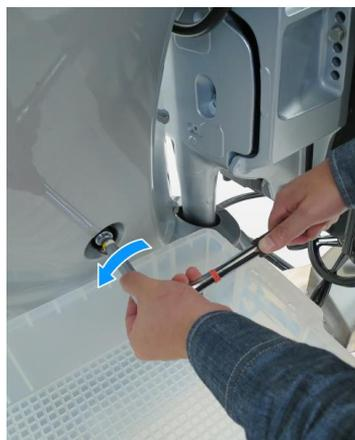
4. Posizionare un contenitore adatto sotto il bullone per lo scarico dell'olio, rimuovere il bullone di scarico dell'olio motore e la rondella. Scaricare l'olio motore fino a quando il flusso dell'olio vecchio non si riduce a un gocciolio.
