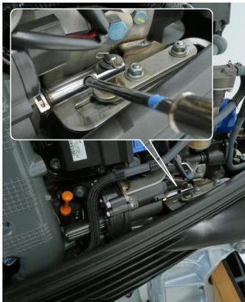
4. Inserire il cacciavite a stella con l'impugnatura del kit nel foro dell'attuatore cambio.
